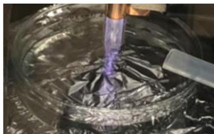
図 1 蒸留水へのプラズマ照射の様子(右側に吸引用のゴム管が見える)
