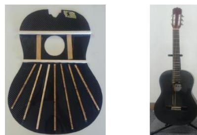
(a) 力木、響材の取り付け (b) 完成したギター
