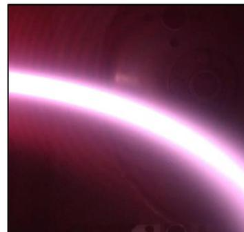
図2 湾曲発散磁場でのプラズマの様子
