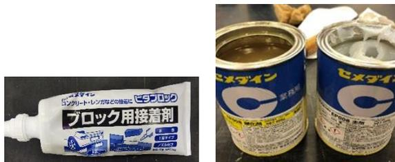
図2 使用したアクリル樹脂系接着剤(左)とエポキシ樹脂系接着剤(右)
